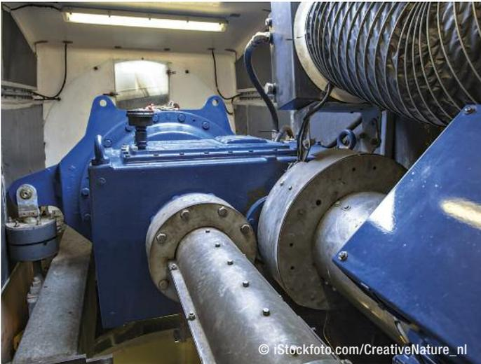
➤ 带有传动系统的风力发电机机舱内部
