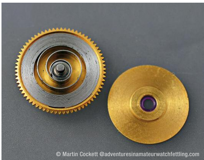
发条盒中的主发条（左），动力释放后进行清洁的发条（右）。由于主发条上紧后受力特别大，因此必须使用特殊工具将其拆下，以免伤及制表师！
