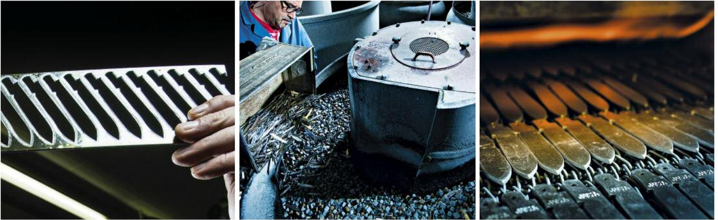
➤ 刀片是用不锈钢带冲压而成，剩下的废料可回收利用（左）在去毛刺机中用陶瓷研磨介质将未加工的不锈钢边缘滚磨光滑（中）每个刀片都经过热处理，使其既坚硬又有韧性（右）。©Victorinox
