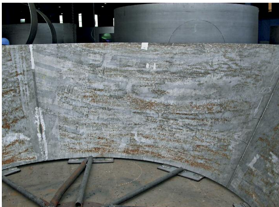
滚压成形加工双相不锈钢板时嵌入的铁 © Gary Carinci, TMR不锈钢
