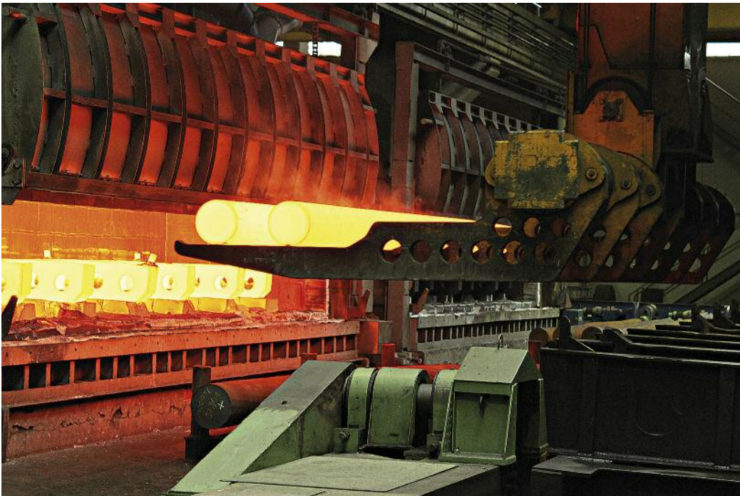
固溶退火之后将红热的双相不锈钢从热处理炉中移走 © Bosch-Gotthard-Hütte
